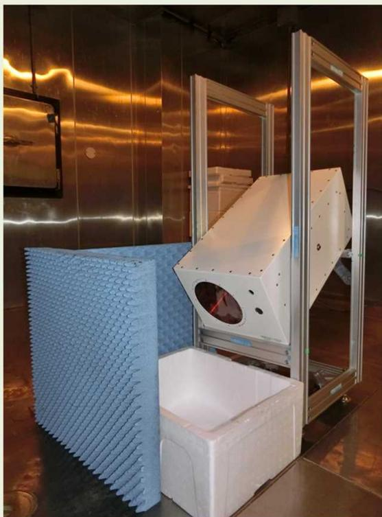
寒冷海域における海水状況の測定精度を向上させるため、現地計測に適した可搬性と周波数を持つ放射計を導入した
