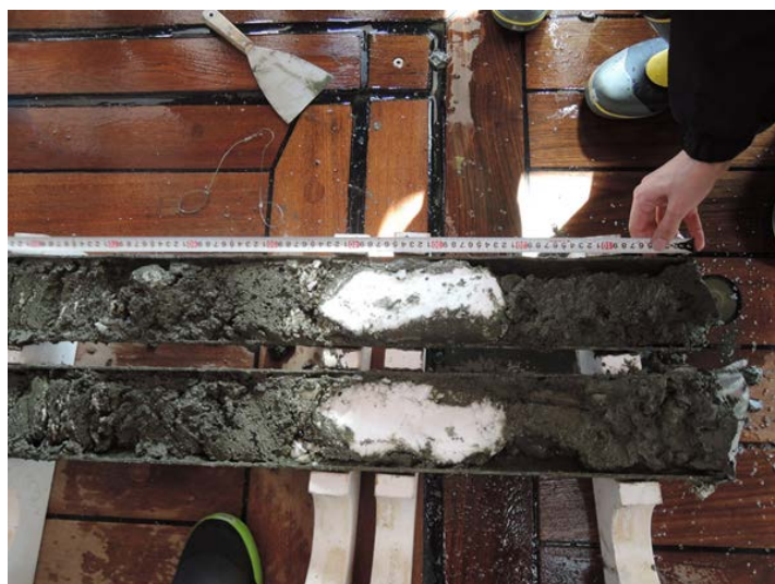
図 1 今回の調査で採取された表層型メタンハイドレート塊
